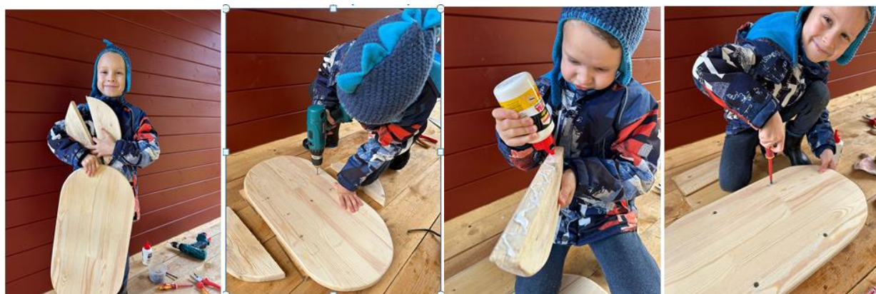
Рисунок 10. Серия фотографий: Два полуовала (две дуги) прикрутили к нижней стороне доски саморезами, предварительно смазав клеем по дереву место стыка
